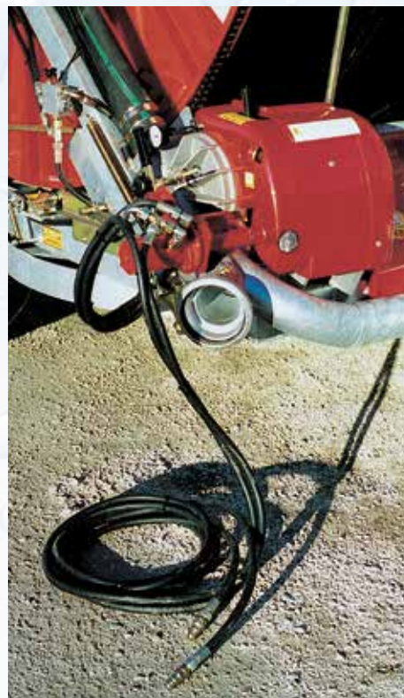
PE tömlő hidraulikus motor révén történő feltekerése a PTO-ra, sebességszabályozó szelep, végállásútköző elosztó és gyorscsatlakozó pár a vontatóhoz
