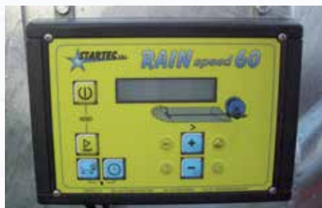
Rain Speed 60 digitális méterszámláló a feltékerési sebesség méréséhez.
