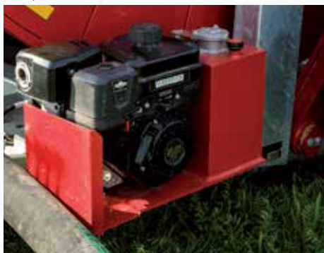
4 ütemű Briggs & Stratton Hp 5,5 motor által vezérelt tápegység a hidraulikus szolgáltatásokhoz.
