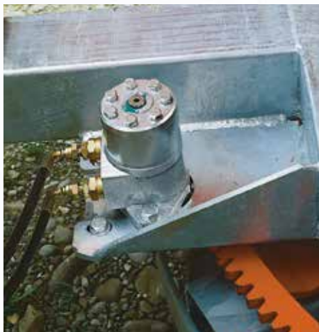
Forgótányér hidraulikus forgása (alapfelszereltségben a 990 Gx, 1000 Gx modelleken, az összes többihez opció).
