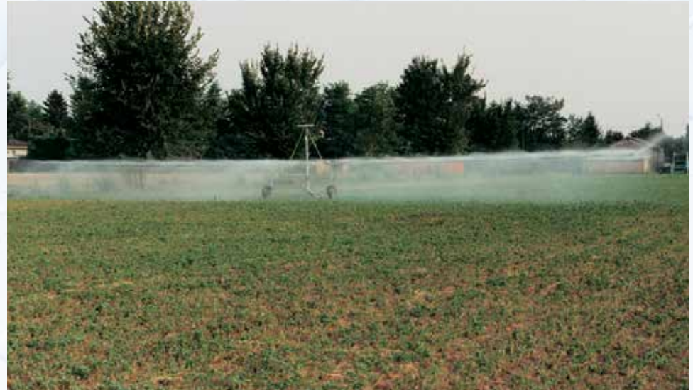
Acél szárny 30 méteres szerkezettel
