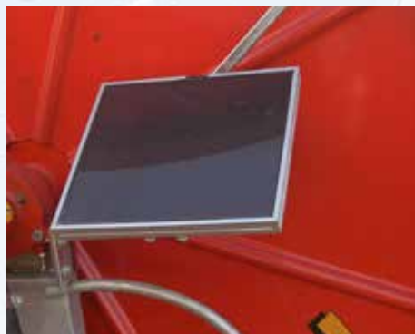
Napelem az elektronikus berendezések ellátásához
