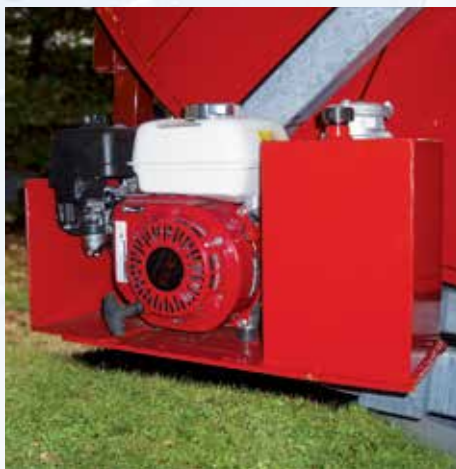
4 ütemű HONDA GX160 motor által vezérelt tápegység a hidraulikus szolgáltatásokhoz.
