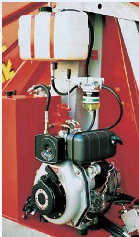
Tömlő feltekerése YANMAR LD70 diesel motorral, melyet hidrosztatikus áttételű, a fordulatszámcsökkentőre szerelt hidraulikus motor; sebességkiegészítő szelep, a szolgáltatások ellátását biztosító dupla hidraulikus szivattyú egészítenek ki; az RM elektronikus programozókkal kombinálható. Az opcióba nem tartozik a turbina.
