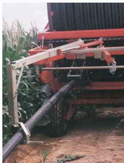
Kar a tömlő hátsó letekeréséhez (opció 790 Gx, 890 Gx, 990 Gx, 1000 Gx modellek esetében), alapfelszereltség Magnum Fx modellen.
