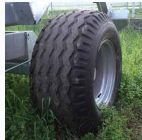
Magas vízfekvésű gumibroncs 890 Gx modellhez, alapfelszereltségben az 1000 Gx szérián (méret 15.0/55-17)
