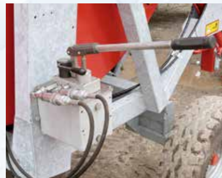
Kézi szivattyú a hátsó konzolok működtetéséhez és a kocs emeléséhez (opció 570 Gx Evo, 581 Gx Evo, 690 Gx, 790 Gx modellekhez).
