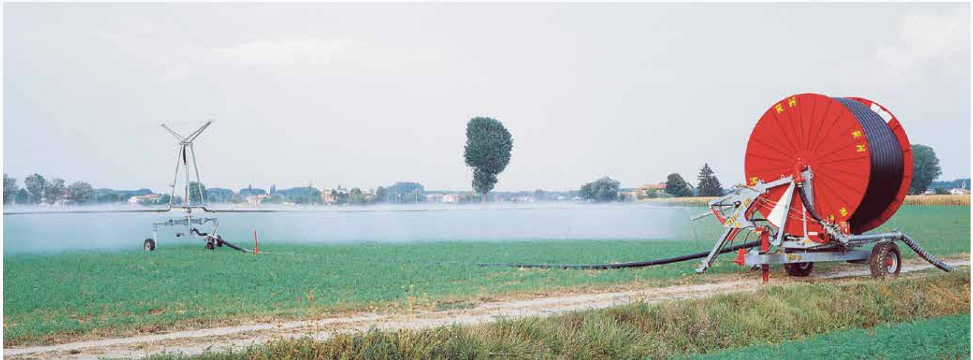
Acél szárny 890 Gx modellre szerelt, 50 méteres szerkezettel
